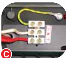
**C** Bornes de ligação, com ponto de aterramento.
