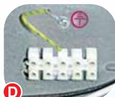
**D** Bornes de ligação, com ponto de aterramento.
