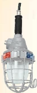
Corpo em liga de alumínio Copper Free de alta resistência mecânica e à corrosão e grade de arame de aço com zincagem eletrolítica, ambos com acabamento em pintura epóxi-poliéster na cor cinza. Parafusos e arruelas em aço inox. Visor de borossilicato e soquetes dimensionados para corresponder às exigências. Para lâmpadas até 100 W. Dotados de terminal de aterramento interno. Fornecido com cabo flexível 3 x 1,5 mm<sup>2</sup> 750 V.
